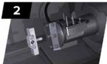
2 Fixez l'adaptateur de matériau AK-1 au support de matériau de la DWX-42W.
